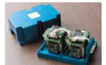
宇宙空間での放射線によるトラブルに備え、2つで一組のユニットとして相互に異常を監視し合うMEMSジャイロスコープ
