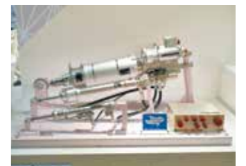
主脚揚降EHA(Electro-Hydrostatic Actuation)システム
