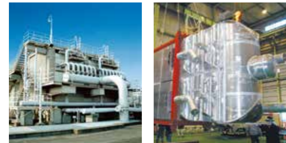
LNG気化装置
