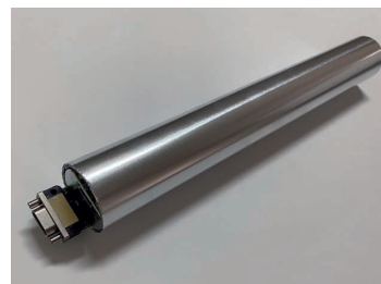
高精度なMEMS慣性センサを搭載し、方位角と姿勢角を検出するノースファインダー™ [GCAH-1X]
