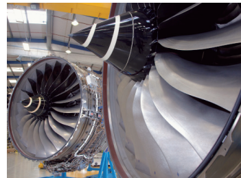
当社の航空機エンジン用熱交換器が搭載されたロールス・ロイス社製のTrent 1000® エンジン
